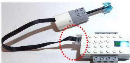
ответ ПРОЦЕСС ПОДКЛЮЧЕНИЯ МОТОРА К СМАРТХАБУ
